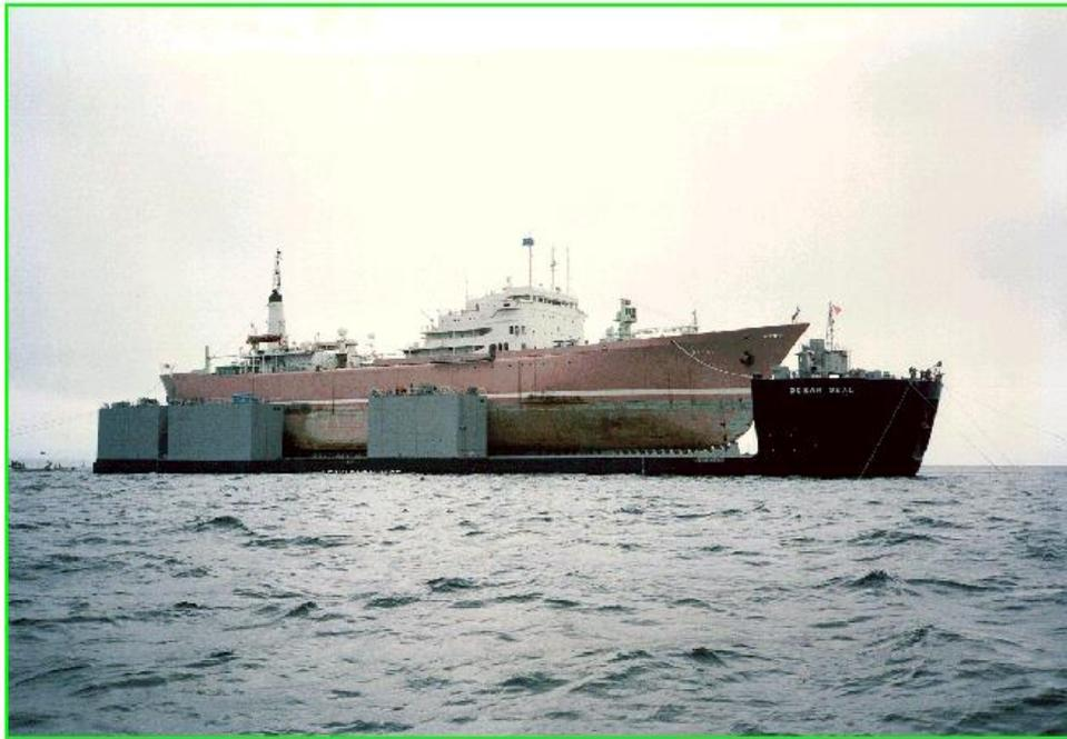
図6 半潜水バージに上架中の状態（出典：日本原子力研究所）
